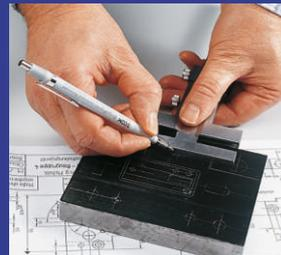
Zum Auswechseln des HM-Einsatzes nur die Mechanik entspannen, den Druckknopf abziehen, die verbrauchte Nadel entnehmen und durch eine neue ersetzen.
